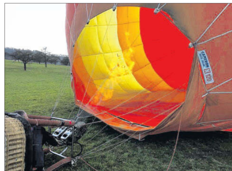
Die Hülle muss kräftig befeuert werden, damit sich der Ballon aufrichtet.
